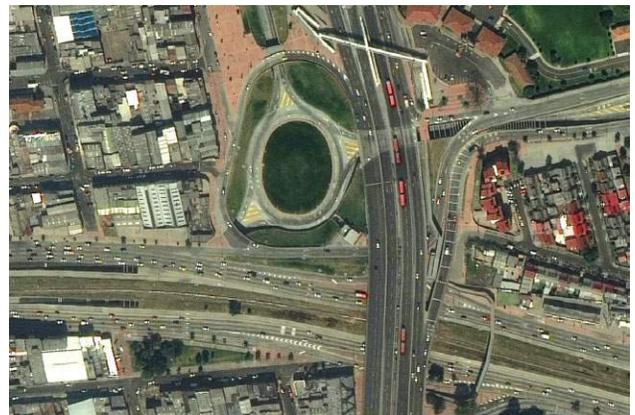
**Figura 74** Interseção entre três corredores TransMilenio: NQS, Calle 80 e Avenida Suba. As conexões de ônibus entre os três corredores são feitas via passarelas e passagens subterrâneas que maximizam a capacidade de todos os movimentos e minimizam os conflitos potenciais entre os ônibus.
