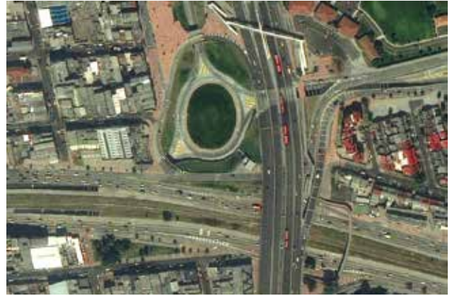
Şekil 74 TransMilenio koridoru üzerindeki üç hattın kesişim noktası: NQS, Calle 80 ve Avenida Suba. Bu üç hat arasındaki otobüs bağlantıları üstgeçitler yoluyla sağlanarak tüm dönüşlerde kapasite azami düzeyde korunuyor ve otobüsler arasındaki muhtemel anlaşmazlıklar önlenabiliyor.
