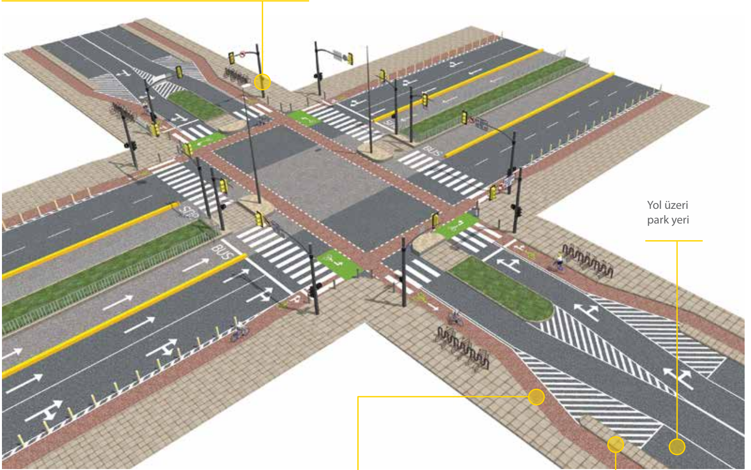
Şekil 35 Dört yönlü küçük kavşaklarda bisiklet dönüşleri
