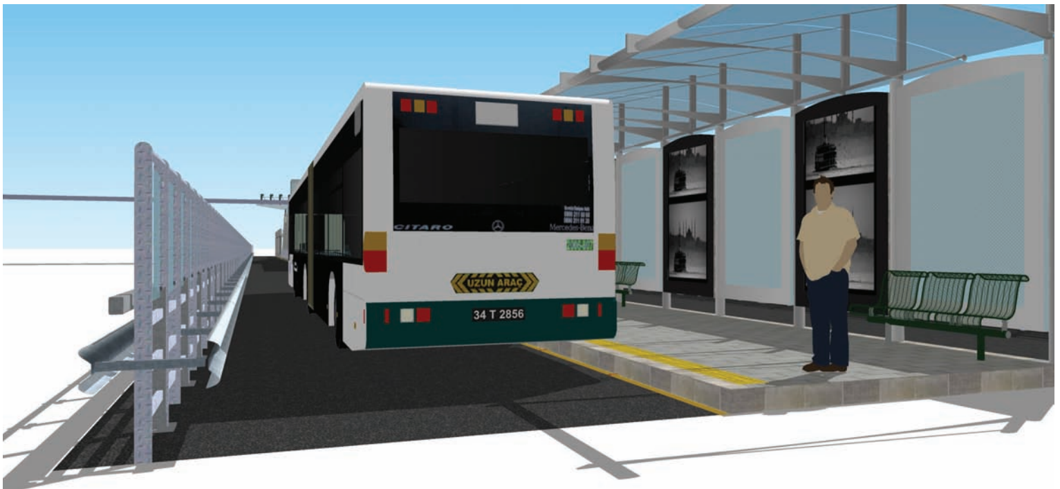
Hình 68 Biện pháp thiết kế minh họa sự kết hợp rào chắn kép và một lan can cao, được khuyến cáo sử dụng cho các BRT chạy trên đường cao tốc.
