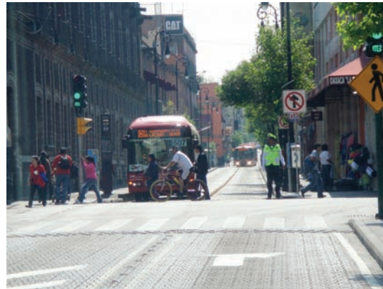
Hình 46 Các biển báo giao thông và mũi tên chỉ đường mới thể hiện kết thúc của làn dùng chung và bắt đầu làn dành riêng cho xe buýt, chỗ mà các phương tiện giao thông hỗn hợp phải rẽ phải.
